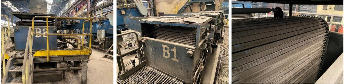
Fig. 24: Filtros Magnéticos A1, A2, B1 y B2
