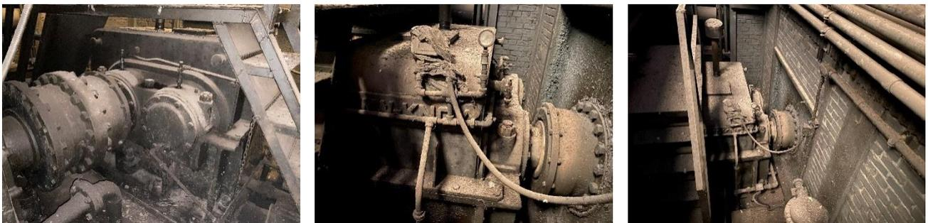
Fig. 40: Coplas (motor-reductor-caja piñones) en los reductores Blaw-know del marco 2 - 3
