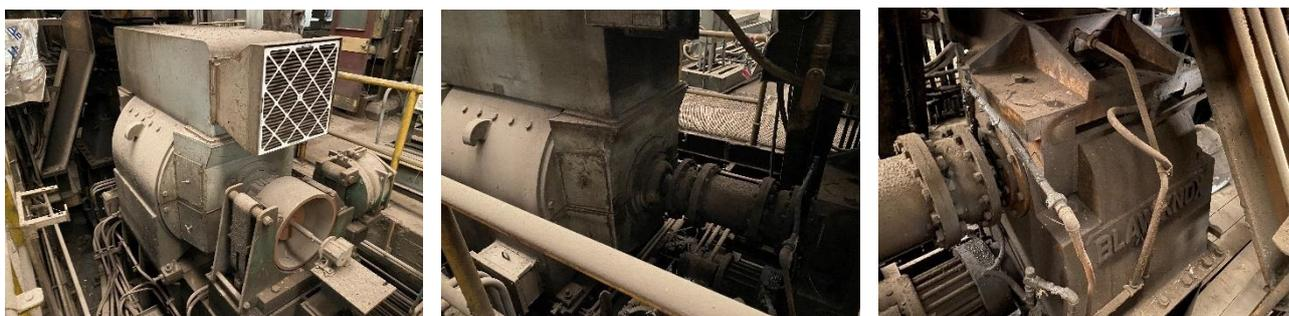
Fig. 41: Motor eléctrico, acoplamiento y reductor de los desenrolladores.
