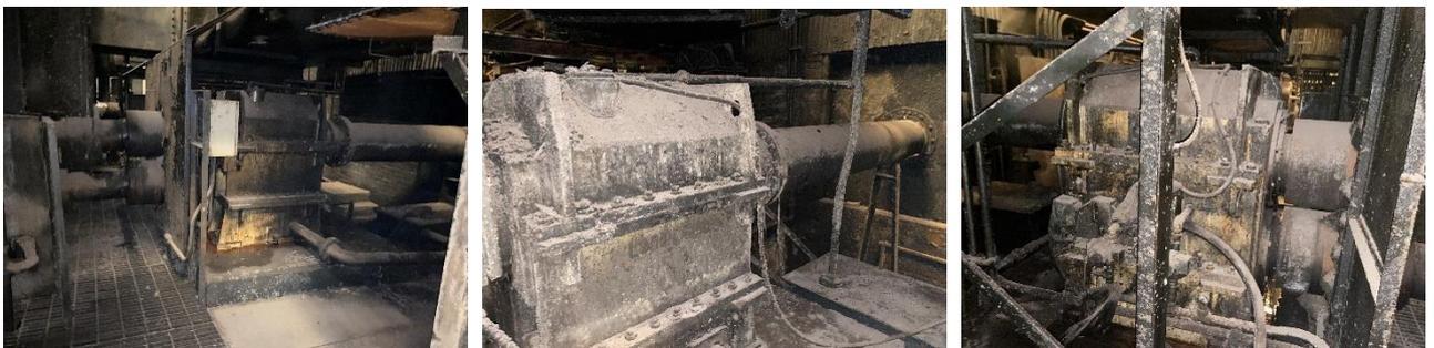
Fig. 41: Ejes de acoplamiento (motor-reductor- rodillo laminación) en reductores Weco de marco 4 - 5
