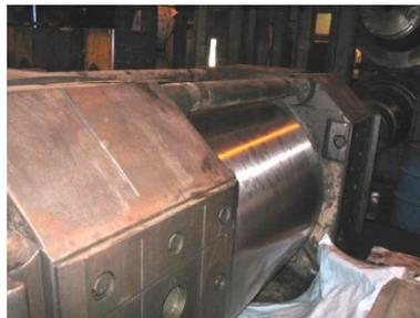
Fig. 6: Rodillo BUR 4 - 5 superior armado
