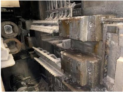
Fig. 19: Boquillas de refrigeración y lubricación M-5.
