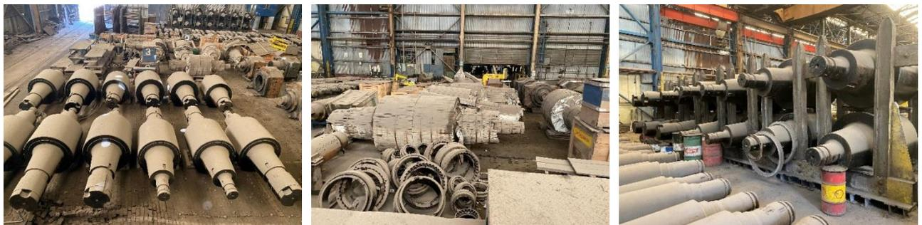
Fig. 4: Rodillos BUR y Trabajo almacenados
