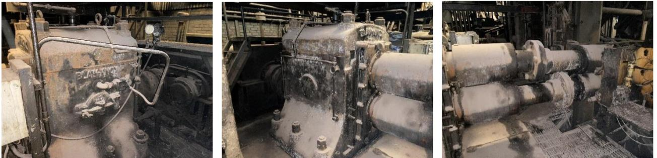
Fig. 39: Cajas de piñones Blaw-knox usadas en marcos 1-2-3 con sus ejes Mainas
