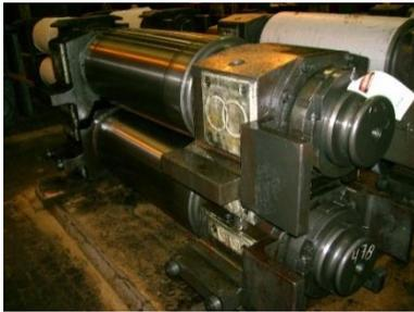
Fig. 5: Rodillo trabajo armado
