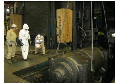
Fig. 7: Desmontaje Rodillo BUR 4-5
